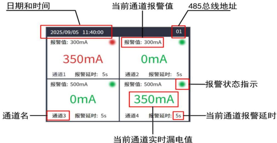
界面显示实时漏电值、报警延时、报警值、通道名、报警状态指示、日期时间、485 总线地址。
